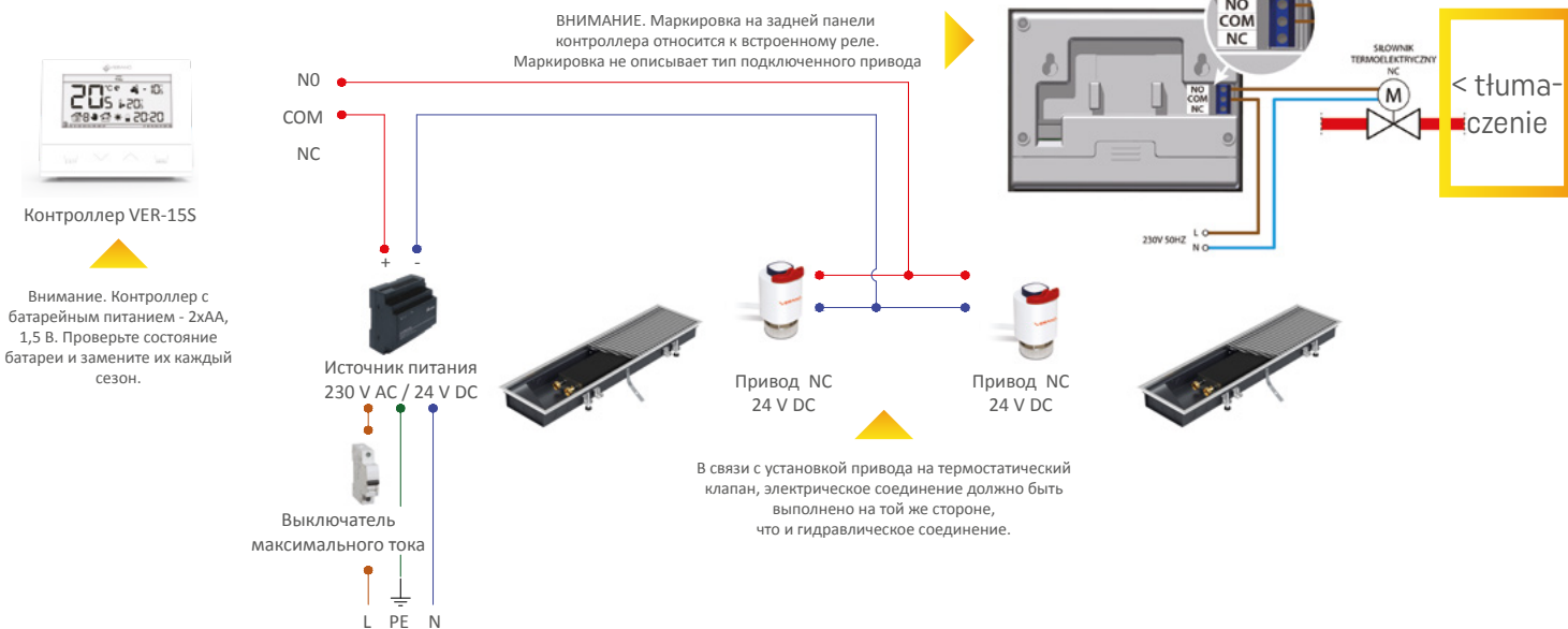
Примерная схема подключения канальных обогревателей VK15 с использованием одного комнатного регулятора и приводов ON/OFF типа NC
